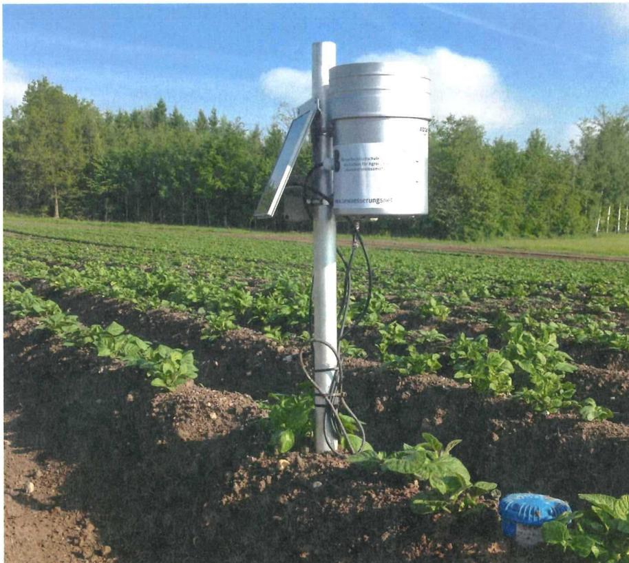
Wann soll die Bewässerung beginnen? Bodensonden helfen bei der Entscheidung und ermöglichen oft ein längeres Zuwarten, wodurch Wasser gespart wird.
