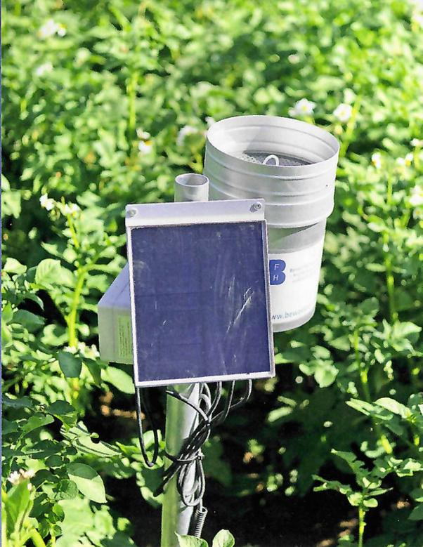
Ein Solar-Panel sorgt für Strom für die Sensoren.
